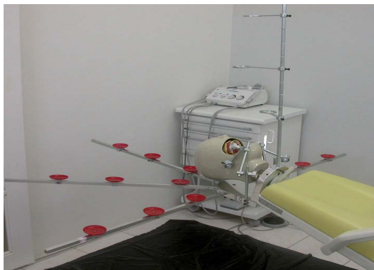
Figura 1 Estrutura do dispositivo metálico acoplado à cadeira odontológica com as hastes e os suportes plásticos delimitando as distâncias de 20 cm, 40 cm e 60 cm do centro da cavidade bucal
